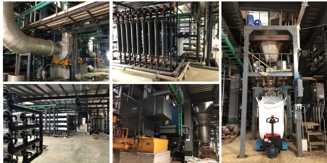
mvr系统 超滤系统 压缩机与强制循环系统 包装系统 反渗透系统
